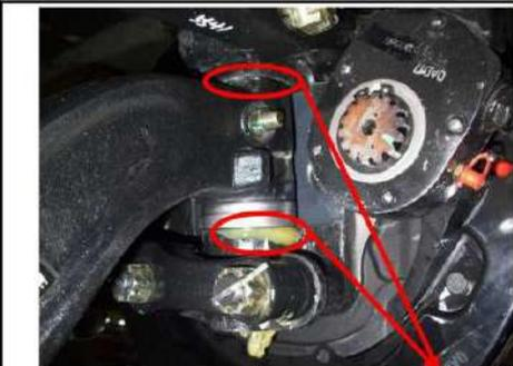
Разлив смазки в двух местах указывают на полное заполнение
