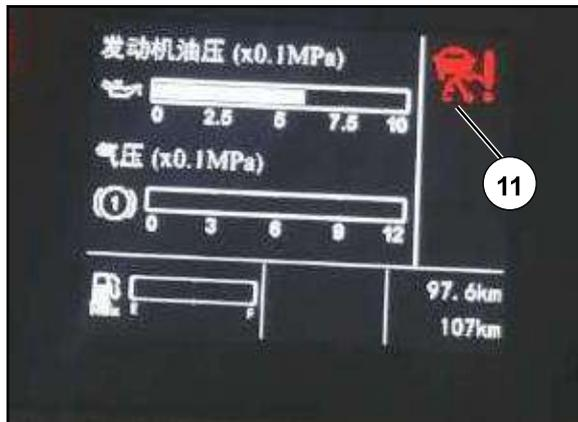
Если на приборе отображается значок (11) (водитель не отключил систему активно), система неисправна, и следует обратиться к пункту обслуживания компании Sinotruk для устранения.
